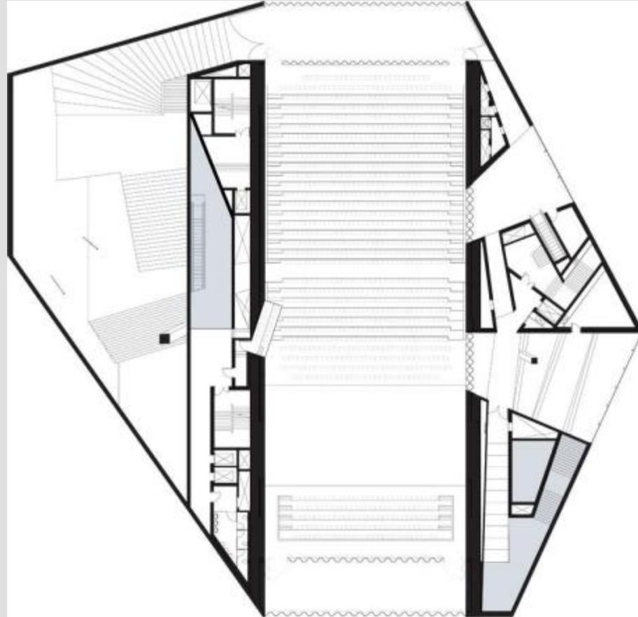
IMAGEM 68: Pplanta baixa 2º piso – Paredes estruturais
