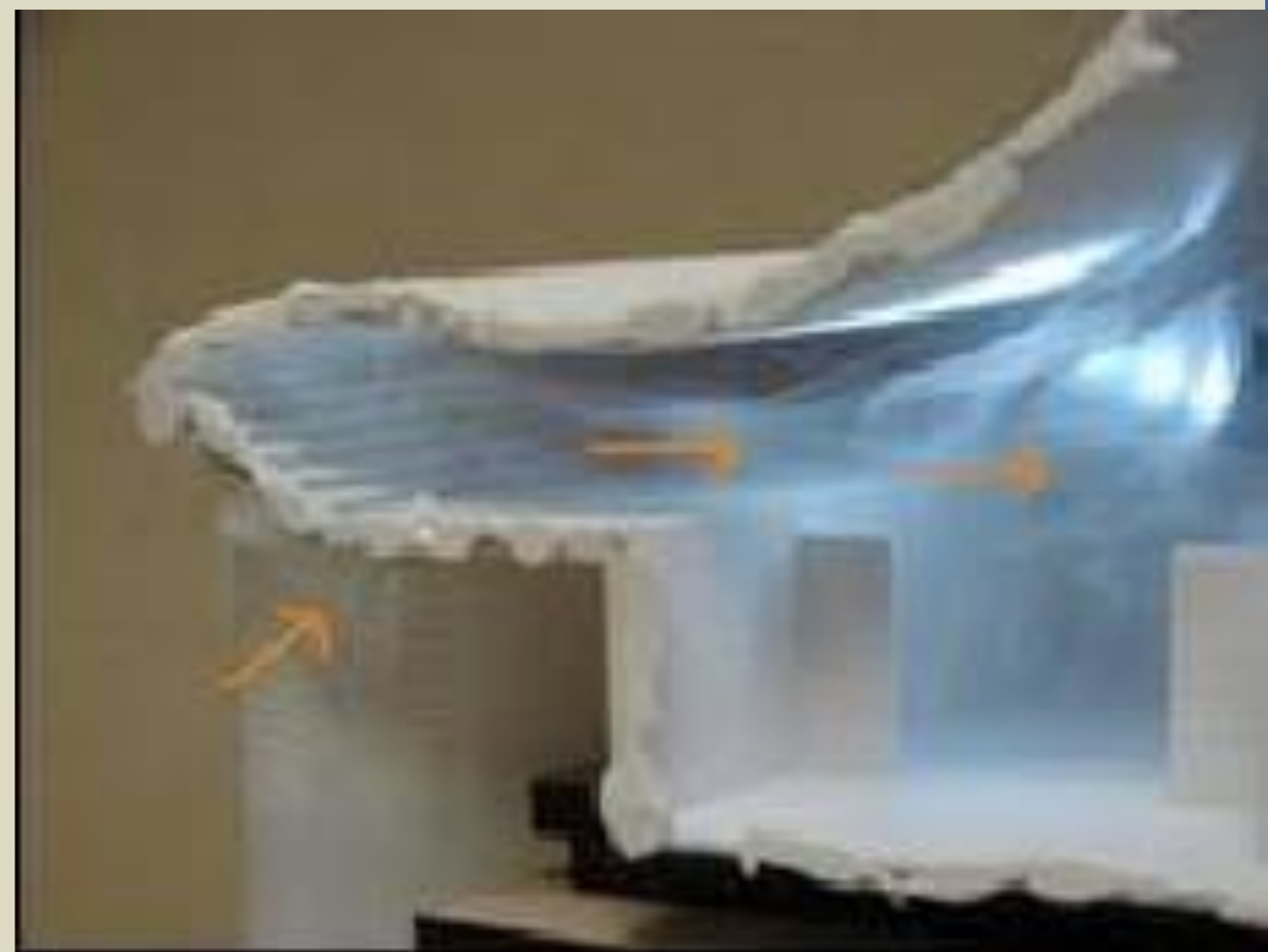
Figura 78: Experimento de circulação de ar no interior de maquete de seção de um edifício hospitalar de Lelé, produzida em impressora 3D.
