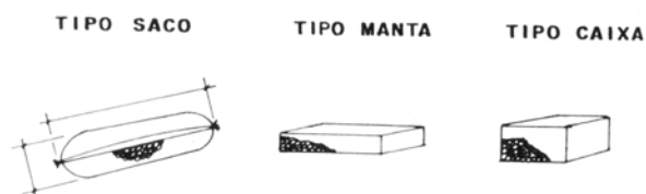
Contenção com gabiões – Fonte IPT
