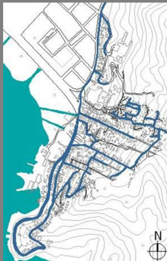
INFRA-ESTRUTURA - Abastecimento de água.
