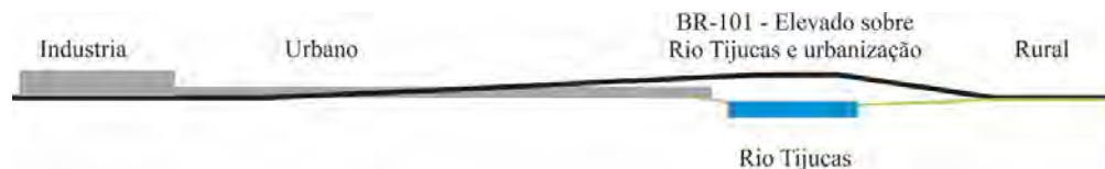
Figura 339: Padrão traçado BR-101 área urbana de Tijucas. Transposição do rio Tijucas dá sequência na forma de elevado por cima da urbanização. De um lado rural e do outro cidade.
