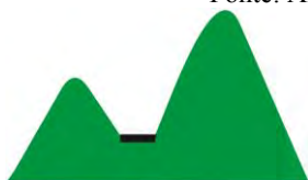
Figura 271: Padrão de pista em área rural entre morros ou serras. Aterro do vale para assentar pistas.
