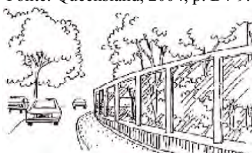
Figura 169: Tratamento alternativo: material transparente para ambiente altamente visual. Fonte: Queensland, 2004, p. B4-11.
