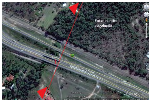
Figura 199: Ampliação rodovia A1 em Stony Creek. Cruzamento de fluxo de pessoas, fauna, estrada de ferro e rodovia. Passagens em níveis diferentes; fauna e pessoas, inferior. Destaque para as pistas que se separam e criam áreas livres vegetadas que dão sequência ao corredor verde. Fonte: Angela Favaretto, 2016, a partir Google Earth, 2016.
