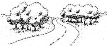
Figura 162: Curvatura do traçado da estrada respondendo às características de vegetação.
