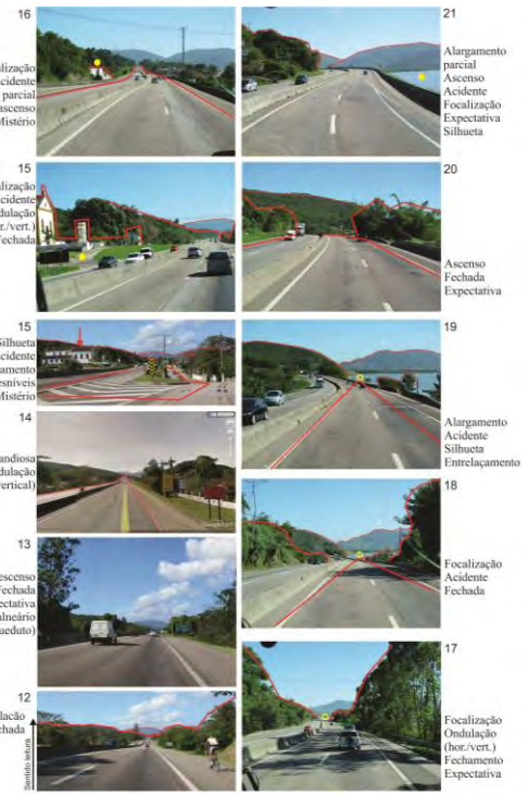
Figura 399: Análise da visão serial e dos efeitos visuais Trecho Cênico Serra São Miguel, segmento B, Biguaçu.
