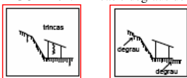
FIGURA 61: Trincas e degraus de abatimento. Fonte: MACEDO (2001: 101)
