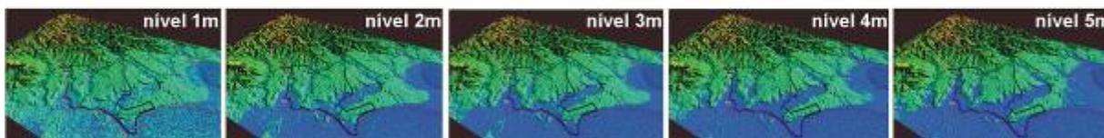
Simulação de inundação com variação dos estágios de aumento do nível de água de 0 a 5m.
