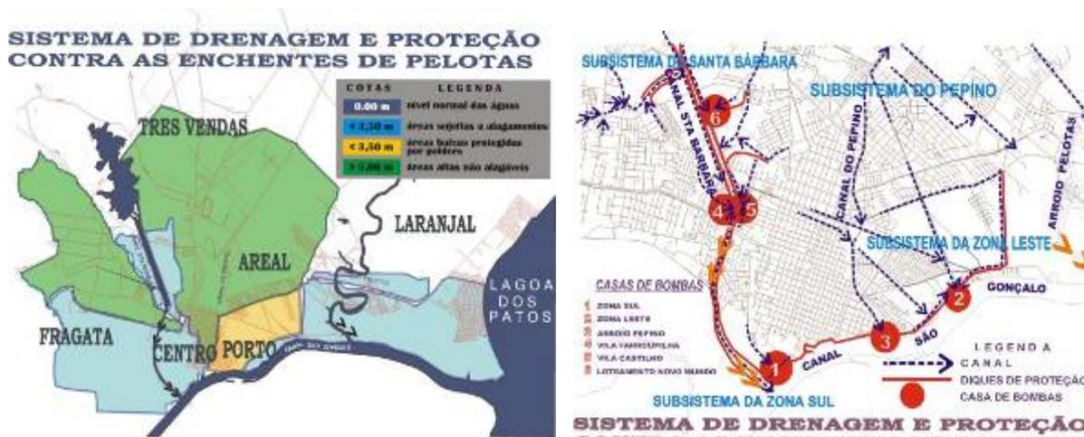
Figura 93: Mapas meramente ilustrativos do funcionamento do Sistema de Drenagem e Proteção contra Enchentes de Pelotas (SANEP, 2000)
