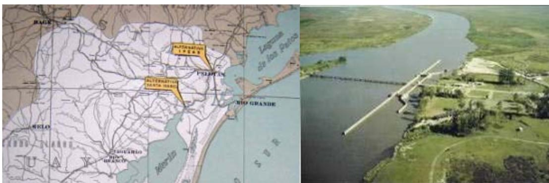
Figura 93: Indicação no mapa e vista aérea da barragem Eclusa, responsável por evitar a salinização das águas do São Gonçalo usadas para irrigação e abastecimento (ALM, 2001)
