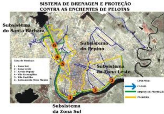
Esquema de funcionamento do sistema de drenagem e proteção contra enchentes, com indicação do sentido de escoamento dos canais, a localização das bombas de recalque, os diques de proteção e os limites das áreas de polder protegidas
