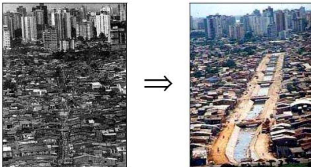
Figura 20: Canalização de corpos d'água por parte do poder público: solução que não garante o fim das inundações do Córrego Pirajá em Belém/PA (Tucci, 2002)
