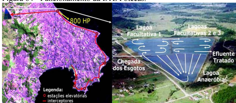
Figura 64 - Funcionamento da ETE Potecas.
