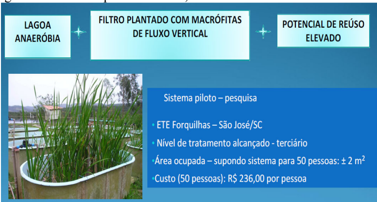
Figura 14 - Sistema piloto de reuso, ETE Potecas.
